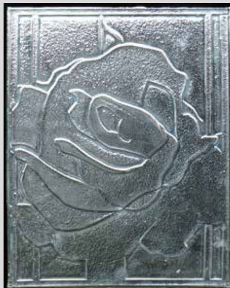
Een glasplaat wordt in de oven op een speciale keramische mat dewelke in de gewenste vorm werd uitgesneden. Bij hoge temperatuur zakt het glas in de sjablonen, waardoor reliëfeffecten en texturen op het glasoppervlak ontstaan
