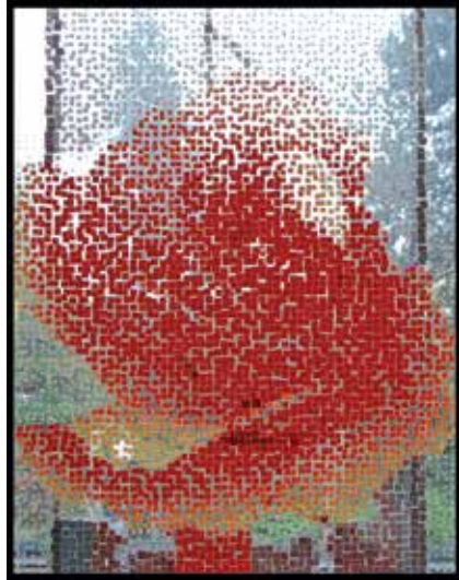
Das der digitale Emaildruck zur Zeit nur in opalisierenden bzw. opaken Glasschmelzfarben realisiert werden kann, ist eine gewünschte Transparenz z.B. durch den Einsatz von Rastern möglich. Hier feinkörniges Raster.
