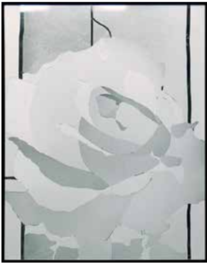
Durch eine vorder- und rückseitige Mattierung durch Sandstrahlung kann der Eindruck von Tiefe entstehen. Das Motiv ändert sich nicht nur je nach Lichteinfall, sondern auch durch Veränderung des Blickwinkels, und je nach Dicke des Materials können Verschiebungen, Überlagerungen oder Öffnungen wahrgenommen werden.
