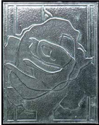
Spezielle Brennunterlagen werden nach Motiv geschnitten und im Brennofen gestapelt und mit einer Glasscheibe gecoverd. Die Layer werden nun bei hoher Temperatur im Glas abgeformt und die Glasscheibe erhält so ihre charakteristische, reliefartige Oberfläche.
