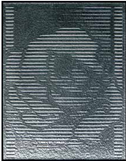
Spezielle Fasermatten werden mit einem Druckmedium versehen. Dieser Siebdrucküberzug schützt das faserige Material beim folgenden Sandstrahlvorgang. Die ungeschützten Bereiche werden so bis zur gewünschten Tiefe reduziert. (Patent Boissel)
