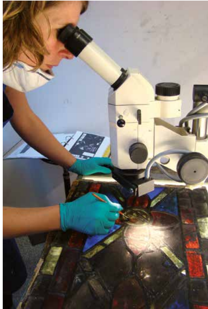
Reinigung unter dem Mikroskop
