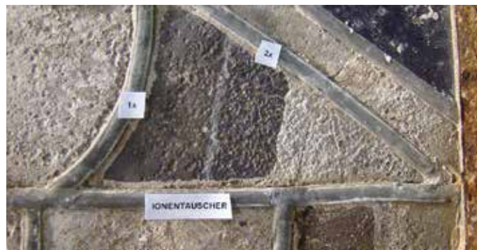
14 Reinigung mit Ionentauscher
